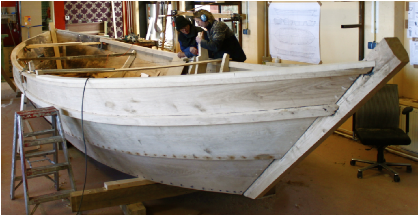
Bouwers Peter van Lieshout en Jochem van Roon bezig met het plaatsen van een spant.
